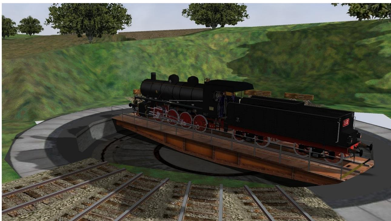
Per ruotare le macchine a vapore con tender è necessaria la piattaforma da 21m, quella diffusissima da 15m era utilizzata in due tempi: si ruotava la locomotiva e il tender separati per poi agganciarli di nuovo. Questa manovra non è possibile per adesso in Open Rails.
